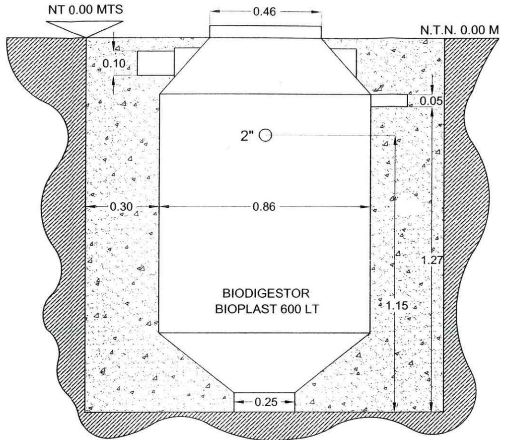
RELLENO CON MATERIAL PRODUCTO DE EXCAVACION EN CAPAS DE 20 CM
