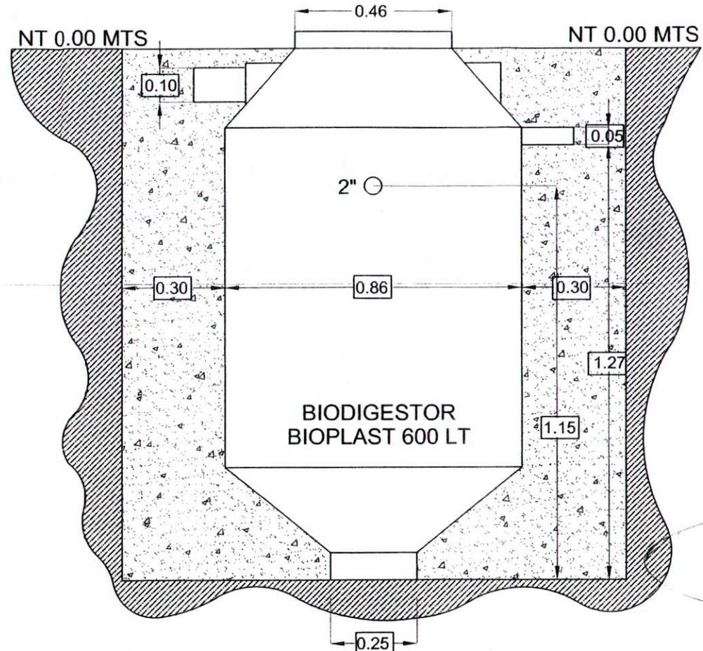
RELLENO CON MATERIAL PRODUCTO DE EXCAVACION EN CAPAS DE 20 CM
